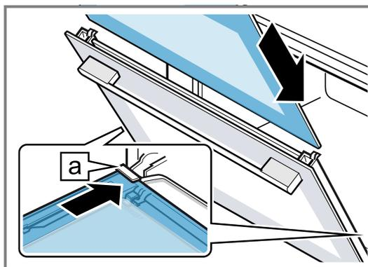
7. Presionar el cristal interior por arriba hasta que quede en la sujeción izquierda y derecha
