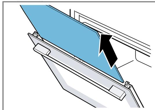
9. En caso necesario, se puede extraer el borde de condensación para limpiarlo.
