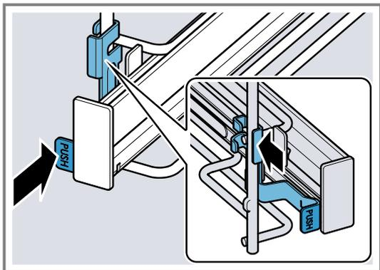
2. Mantener pulsado **PUSH** ① e inclinar el riel hacia fuera ② hasta que la sujeción delantera ③ se desenganche.
