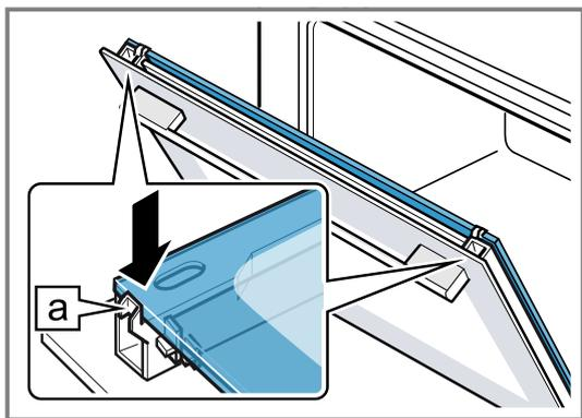
8. Colocar la cubierta de la puerta ① y presionar hasta que se oiga que ha encajado.
