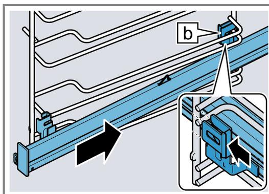
3. Mantener pulsado **PUSH** ① e inclinar el riel de extracción hacia dentro ② hasta que la sujeción ③ se enganche en la varilla inferior.
