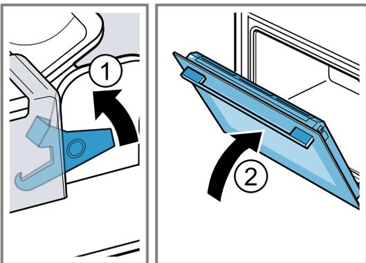
4. Presionar la cubierta de la puerta a izquierda y derecha desde fuera ① hasta que se desenganche.
