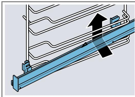
2. Guiar el riel a lo largo de las varillas de guía hacia atrás y deslizar las dos sujeciones en la varilla inferior. Al hacerlo, agarrar la varilla vertical con la sujeción trasera ④.
