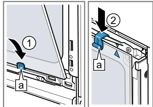
4. Enganchar el cristal delantero por abajo en las sujeciones [a] izquierda y derecha ①.
