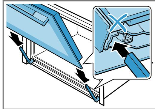
2. Presionar la cubierta desde arriba a izquierda y derecha de la puerta con ambas manos para comprobar si la puerta del aparato se ha introducido hasta el tope.
