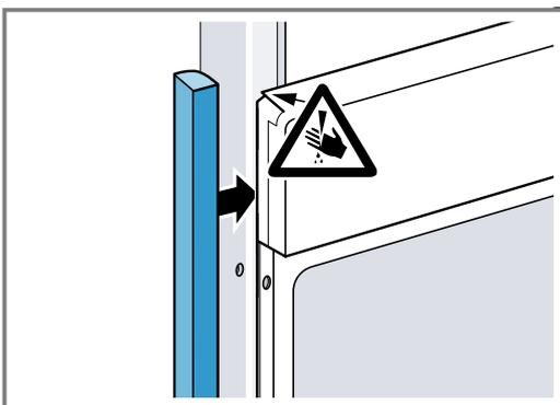
2. Fijar la pieza de relleno al mueble.
