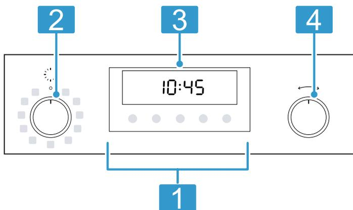
**Hinweis:** Je nach Gerätetyp sind die Schaltergriffe versenkbar. Zum Einrasten und Ausrasten drücken Sie in der Nullstellung auf den Schaltergriff.
