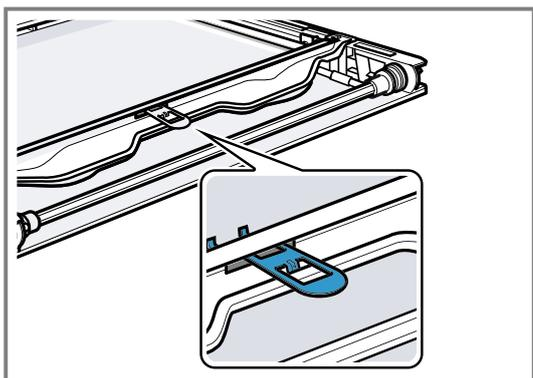
6. Die Innenscheibe so auf die Gerätetür legen, dass die Nummer  $\text{a}$  rechts unten lesbar ist. Die Innenscheibe schräg nach hinten in die Befestigungsschiene  $\text{b}$  einsetzen.
