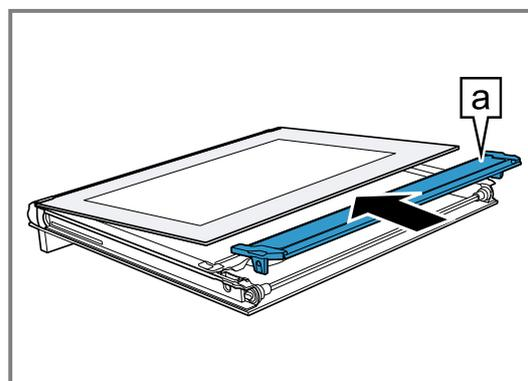
8. Die Innenscheibe mit der Halterung  $\text{a}$  in die Öffnung einsetzen.
