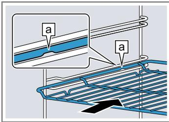
**Blech** z. B. Universalpfanne oder Backblech Das Blech mit der Abschrägung
