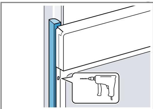
4. Das Gerät mit adäquater Schraube befestigen.
