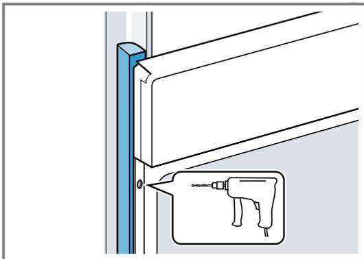
4. Das Gerät mit adäquater Schraube befestigen.
