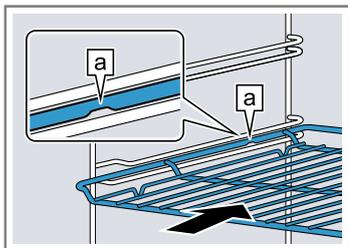
Blech Das Blech mit der Abschrägung [a] zur Gerätetür einschieben.
