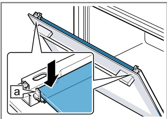
5. Die Gerätetür öffnen und Türdichtung einhängen.
