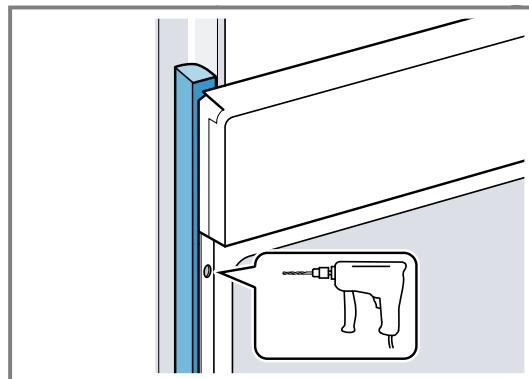
4. Das Gerät mit adäquater Schraube befestigen.
