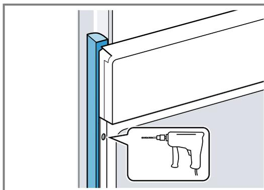
4. Das Gerät mit adäquater Schraube befestigen.
