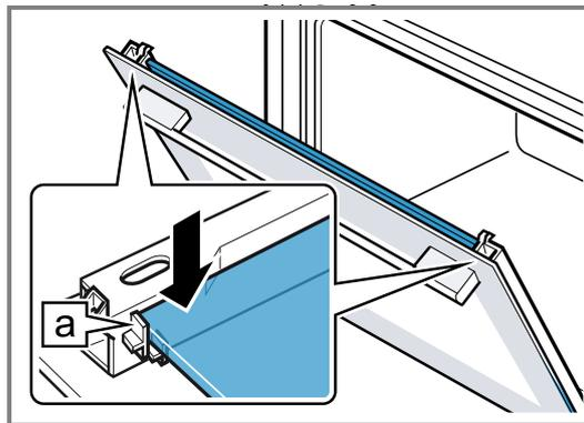
5. Die Gerätetür öffnen und Türdichtung einhängen.
