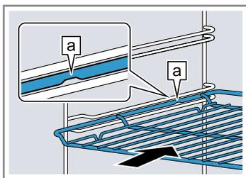
Blech Das Blech mit der Abschrägung [a] zur z. B. Universalpfanne Gerätetür einschieben.
