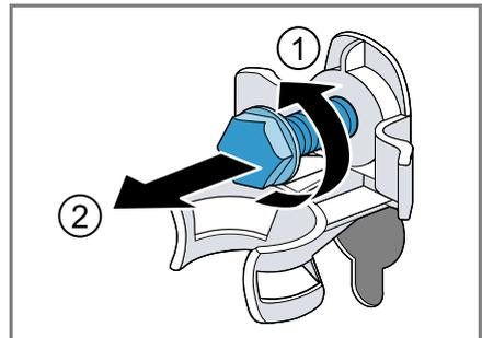
**3.** Die 4 Hülsen entfernen.
