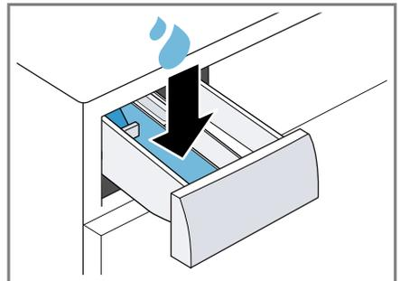
5. Pulvervollwaschmittel mit Sauerstoffbleiche in die Kammer II einfüllen.
