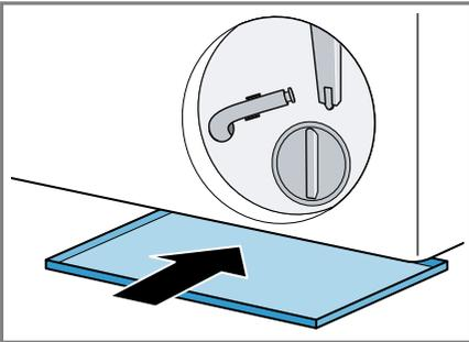
6. Den Entleerungsschlauch aus der Halterung nehmen.
