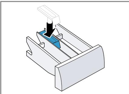
6. Die Öffnung für die Waschmittelschublade reinigen.
