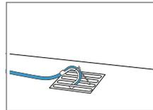
Deslizar la manguera de salida de agua completamente por el racor en codo y fijarla con el material de fijación. Fijar el racor en codo en el canal.
