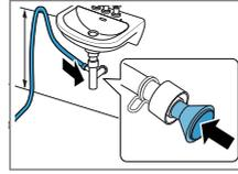
Fijar la manguera de desagüe con un tubo guía a una altura mínima de 80 cm y máxima de 100 cm.
