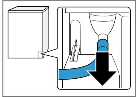
La manguera de agua condensada viene conectada a la boquilla de fábrica.
