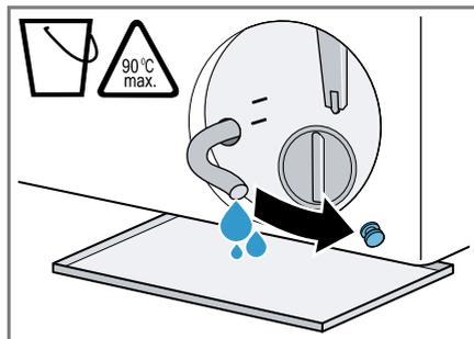
8. Appuyez sur le bouchon de fermeture.
