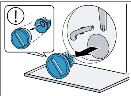
2. Nettoyez le compartiment intérieur, le filetage du couvercle de la pompe et le carter de pompe.
