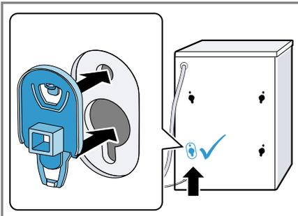
**Hinweis:** Um die Transportsicherungen für den Transport in das Gerät einzusetzen, machen Sie diese
