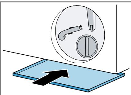
6. Den Entleerungsschlauch aus der Halterung nehmen.
