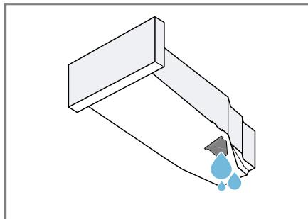
Controllare regolarmente il filtro del contenitore dell'acqua di condensa → Pagina 42 e pulire un filtro sporco.
