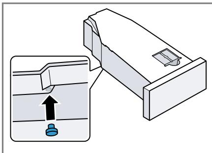
3. Pulire il filtro nel contenitore dell'acqua di condensa.
