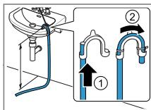
Spostare completamente il tubo flessibile di scarico dell'acqua attraverso il collettore
