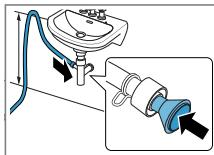
Fissare il tubo flessibile di scarico dell'acqua con una guida del tubo flessibile a un'altezza minima di 80 cm e massima di 100 cm.
