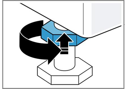
Sujetar firmemente las patas del aparato sin modificar la altura.
