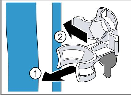
2. Aflojar ① y retirar ② todos los tornillos de los cuatro seguros de transporte con una llave de tuercas de abertura 13.
