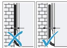
No apriionar las mangueras ni el cable de conexión a la red entre la pared y el aparato.
