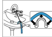
Fijar y asegurar la manguera de desagüe con un racor en codo.
