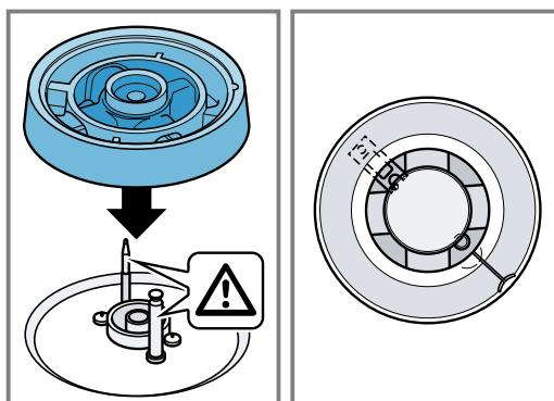
4. Las lengüetas de retención del círculo de llama del quemador encajan en el hueco del cabezal.
