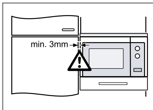
La distance par rapport aux appareils adjacents doit d'être d'au moins 3 mm.
