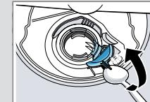
5. Levante a tampa da bomba de forma inclinada para dentro e retire.
