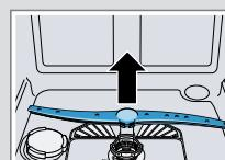
3. Verifique a existência de entupimentos nos orifícios de saída dos braços aspersores sob água corrente e, se necessário, remova os corpos estranhos.
