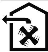
Poistoilmaa ei saa johtaa hormiin, jota käytetään kaasua tai muita polttoaineita polttavien laitteiden pakokaasun poistoon (tämä ei koske kiertoilmalaitteita).
