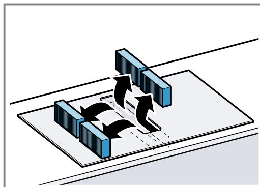
4. Sett inn de 2 luktfiltrene eller støyfiltrene på venstre og høyre side i apparatet, og skyv dem forover.
