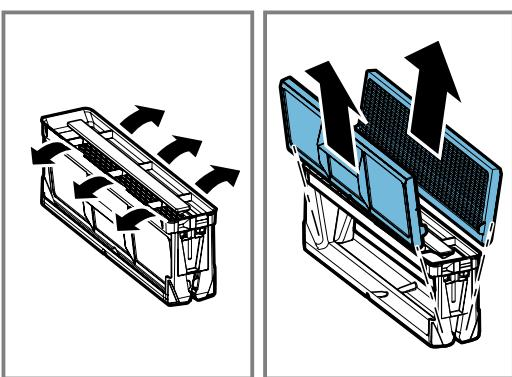
2. Sett de enkelte komponentene til fettfilteret løst i oppvaskmaskinen uten at de kommer i klem.
