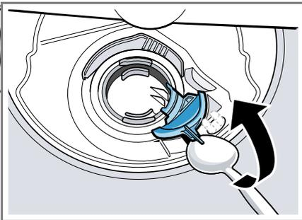
6. Die Pumpenabdeckung schräg nach innen anheben und entnehmen.
