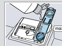
3. Fermez le couvercle du réservoir de liquide de rinçage.
