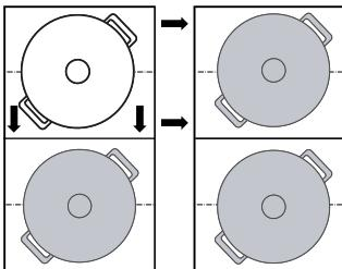
Gryden / panden bliver registreret, og i indikatoren for den nye kogezone blinker det forinden valgte effekttrin og skiftevis.
