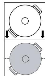
La stoviglia viene riconosciuta e sull'indicatore della nuova area di cottura lampeggiando in modo alternato il livello di potenza precedentemente selezionato e  $L$ .
