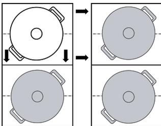
O recipiente para cozinhar é detetado e na indicação do novo disco piscam alternadamente a potência de cozedura previamente selecionada e .
