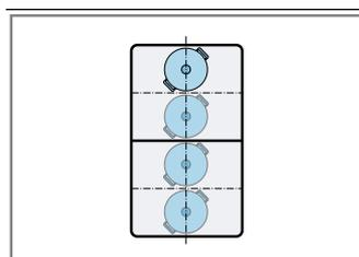
Bei einem Durchmesser bis 13 cm das Kochgeschirr in einer der vier Positionen gemäß Abbildung positionieren.
