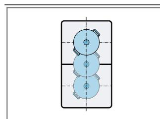
Bei einem Durchmesser über 13 cm das Kochgeschirr in einer der drei Positionen gemäß Abbildung positionieren.
