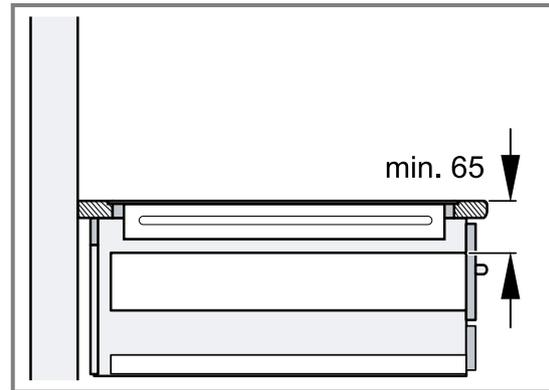
**Hinweis:** Nur eine Zwischenablage aus Holz verwenden, wenn Metallobjekte in der Schublade aufgrund der rezirkulierenden Luft durch die Lüftung des Kochfelds hohe Temperaturen erreichen.
