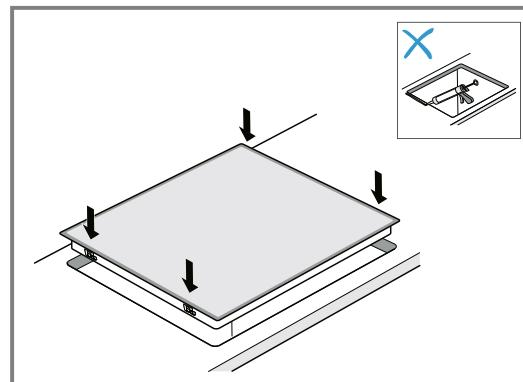
2. Pri delovnih pultih, obloženih s keramičnimi ploščicami, reže med ploščicami zatesnite s silikonom.
