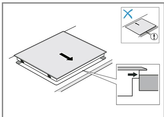
2. Inserire il piano cottura nell'apertura.
