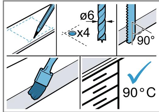
7. Staub und Rückstände der Ausschnittarbeiten entfernen. Die Schnittflächen hitzebeständig und wasserdicht versiegeln.
