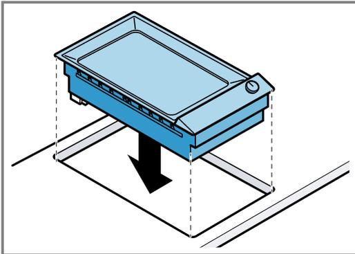
5. Das Gerät mit den 4 beiliegenden Klammern an der Vorderseite und an der Rückseite von unten befestigen.
