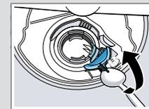
5. Levante a tampa da bomba de forma inclinada para dentro e retire.
