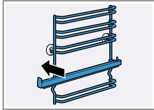
Les supports s'adaptent à droite et à gauche. Les niveaux d'enfournement 1 et 2 se trouvent en bas, les niveaux d'enfournement 3, 4 et 5 en haut. Extrairez le rail de sortie vers l'avant.
