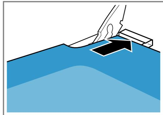
Insérez la vitre dans les deux ouvertures du bas. La face lisse doit être à l'extérieur, la face rugueuse à l'intérieur.
