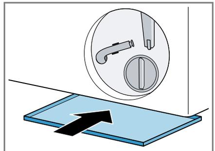
6. Den Entleerungsschlauch aus der Halterung nehmen.
