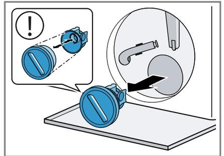
Der Pumpendeckel besteht aus zwei Bauteilen die zur Reinigung auseinandergelöst werden können.
