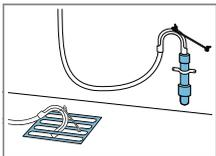
Den Wasserablaufschlauch mit einem Krümmer fixieren und sichern.
