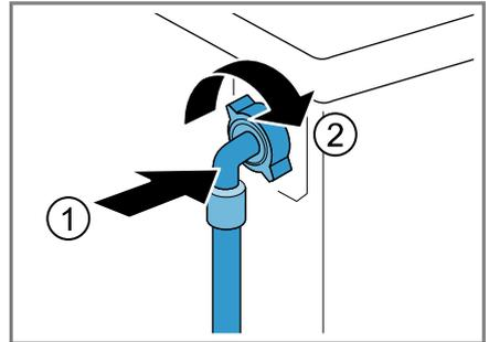
2. Den Wasserzulaufschlauch am Wasserhahn (26,4 mm = 3/4") anschließen.
