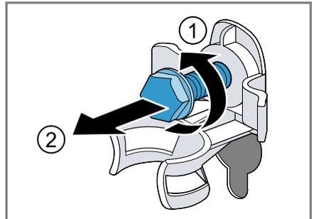
3. Die Netzanschlussleitung von der Halterung entfernen.
