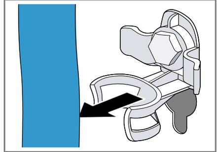
2. Alle Schrauben der 4 Transportsicherungen mit einem Schraubenschlüssel der Schlüsselweite 13 lösen ① und entfernen ②.
