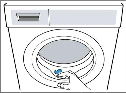
4. Die Gerätetür und die Waschmittelschublade offen lassen, damit Restwasser abtrocknen kann.
