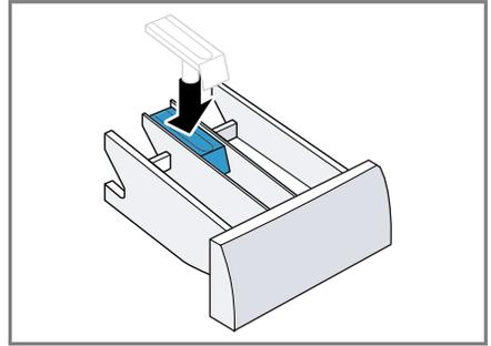
6. Die Öffnung für die Waschmittelschublade reinigen.
