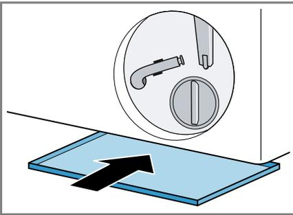
6. Den Entleerungsschlauch aus der Halterung nehmen.
