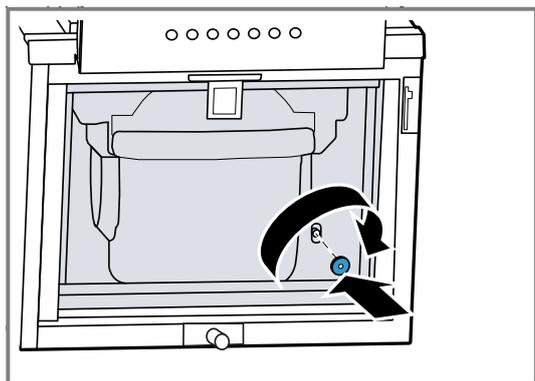
4. Die Glasstütze in die Öffnung einsetzen und bis zum Anschlag nach unten klappen.
