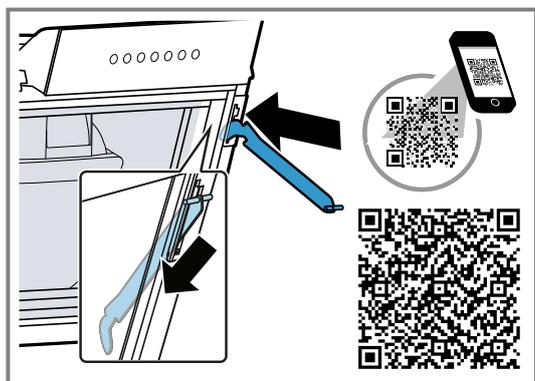
5. Die Glasscheibe im Winkel von 90° zum Gerät ausrichten.
