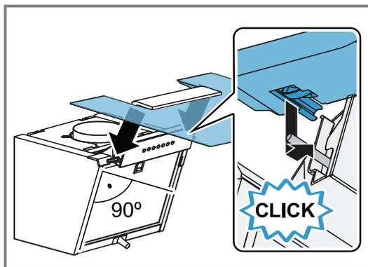
7. Die Glasstütze in die Öffnung an der Glasscheibe einführen und einrasten.
