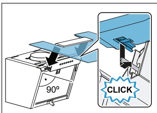
9. Die Glasstütze in die Öffnung an der Glasscheibe einführen und einrasten.
