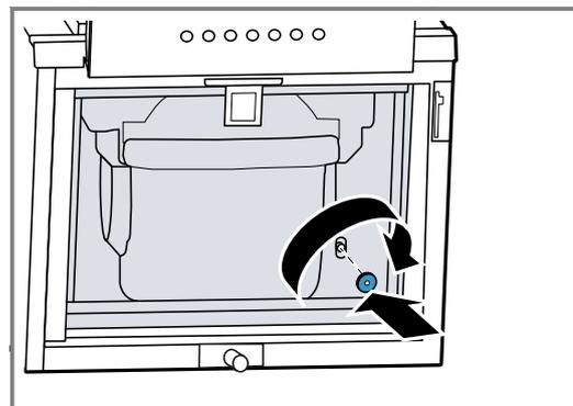
4. Den vorderen Filterhalter schräg oben ansetzen und in die Laschen einführen. Den Filterhalter unten eindrücken, sodass er hörbar einrastet.
