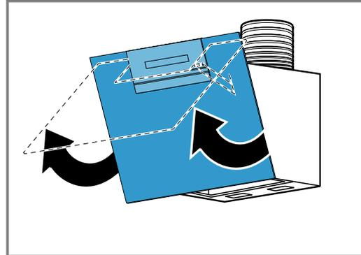
2. Den vorderen Geruchsfilter unten ansetzen ① und nach oben klappen ②.
