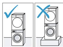
Ovaj uređaj postavite u stub sa mašinom za pranje i za sušenje veša samo sa setom za povezivanje proizvođača maštine za sušenje veša.
