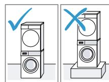
Aparat postavite v pralno-sušilni stolp samo z originalnim kompletom za povezavo proizvajalca sušilnika.
