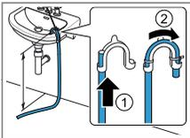
Den Wasserablaufschlauch komplett durch den Krümmer → Seite 12 schieben und mit dem Befestigungsmaterial fixieren. Den Krümmer in maximal 100 cm Höhe befestigen.
