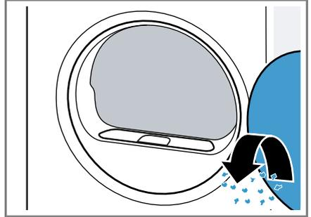
3. Das zweiteilige Flusensieb entfernen.
