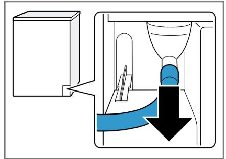
Der Kondenswasserschlauch ist werkseitig am Stutzen angeschlossen.
