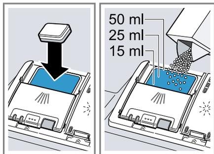
Se utilizar pastilhas, basta uma pastilha. Coloque a pastilha transversalmente.
