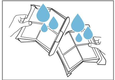
9. Die beiden Flusensiebe schließen und zusammensetzen.
