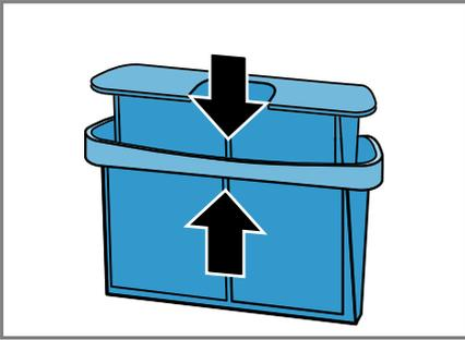
10. Das zweiteilige Flusensieb einsetzen.
