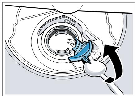
6. Levantar a tampa da bomba de forma inclinada para dentro e retirar.
