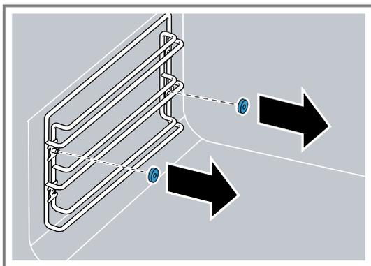
3. Die Einschubroste etwas seitlich von der Schraube wegziehen ① und nach vorn herausziehen ②.
