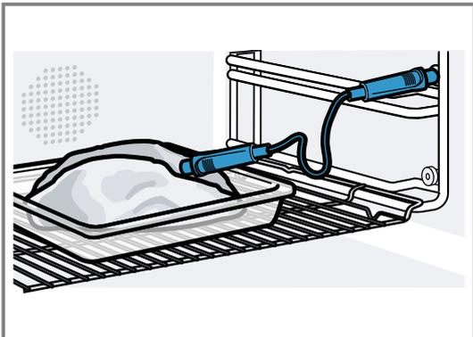
2. Bei mehreren Stücken, den Kerntemperaturfühler in die Mitte des dicksten Stücks stecken.
