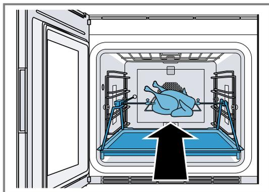
11. Die Antriebsachse in die Öffnung an der Geräterückwand einrasten.
