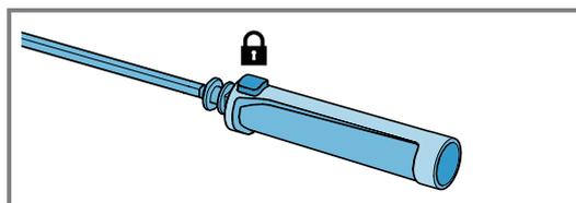
3. Die rechte Halteklammer auf den Drehspieß stecken und mit der Fixierschraube festschrauben.
