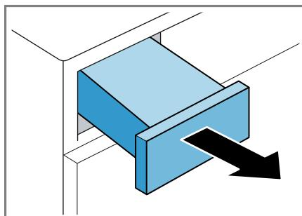
2. Vider le réservoir d'eau de condensation.
