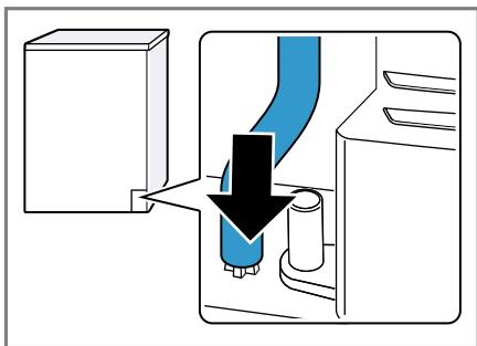
3. Poussez le tuyau d'évacuation d'eau sur le manchon jusqu'en bûtee.
