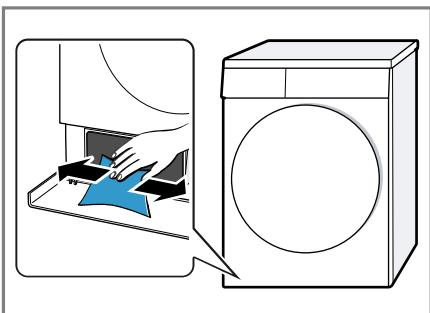
6. Insérez l'échangeur thermique à l'horizontale jusqu'en butée.
