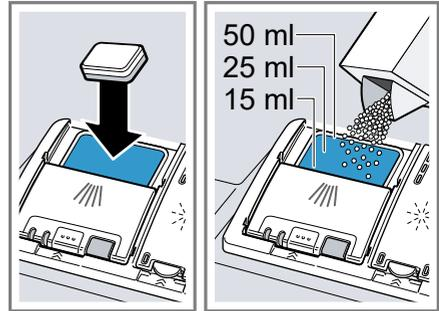
Wenn Sie Tabs verwenden, genügt eine Tablette. Tabs quer einlegen. Wenn Sie Pulverreiniger oder Flüssigreiniger verwenden, beachten Sie die Dosierungshinweise des Herstellers und die Dosierungsein­teilung der Reinigerkammer. Bei normaler Verschmutzung genü­gen 20 ml – 25 ml Reiniger. Bei wenig verschmutztem Geschirr ge­nügt eine etwas geringere als die angegebene Reinigermenge.
