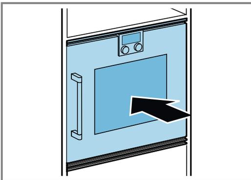
4. Das Gerät mittig ausrichten. Zwischen dem Gerät und den angrenzenden Möbelfronten ist ein Luftspalt von 2 mm erforderlich.
