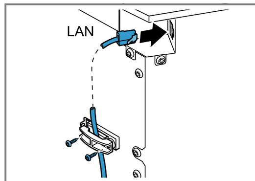
3. Das LAN-Kabel mit einem Netzwerkanschluss verbinden.
