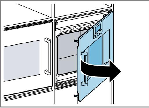
2. Beide Schrauben am unteren Türscharnier lösen.
