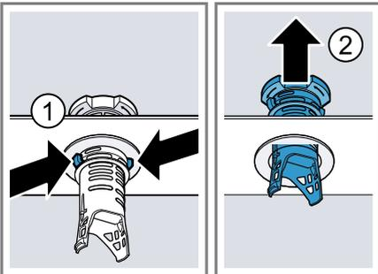
5. Unter fließendem Wasser die Siebelemente reinigen.
