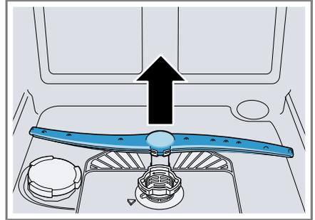
3. Unter fließendem Wasser die Austrittsdüsen der Sprüharme auf Verstopfungen prüfen und gegebenenfalls Fremdkörper entfernen.
