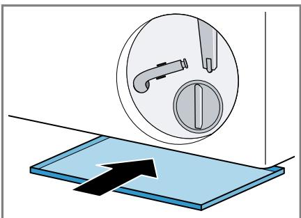
6. Den Entleerungsschlauch aus der Halterung nehmen.
