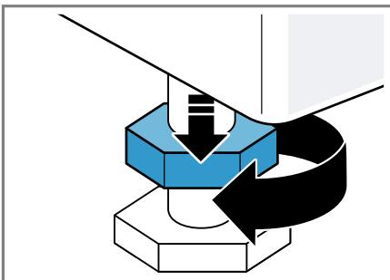
2. Um das Gerät auszurichten, die Gerätetüße drehen. Die Ausrichtung mit einer Wasserwaage prüfen.
