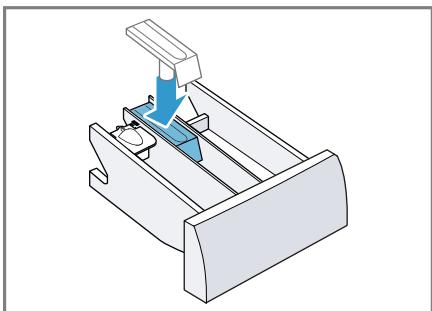
6. Die Öffnung für die Waschmittelschublade reinigen.
