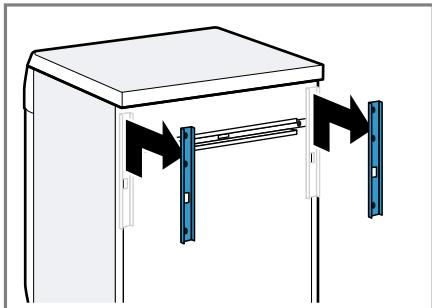
3. Die Schrauben der horizontalen Transportstrebe mit einem Schraubendreher T20 lösen und entfernen.
