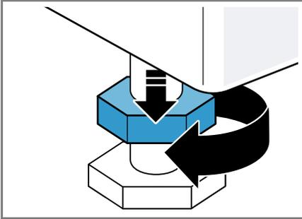
2. Um das Gerät auszurichten, die Gerätefüße drehen. Die Ausrichtung mit einer Wasserwaage prüfen.
