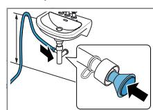
Sikre koblingspunktet med en slangeklemme (12–22 mm). Fest avløpsslangen med en slangeføring i en
