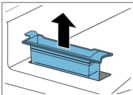
2. Rengjør filteret i varmt, rennende vann eller i oppvaskmaskinen.
