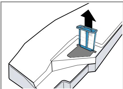
3. Rengjør filteret i varmt, rennende vann eller i oppvaskmaskinen.
