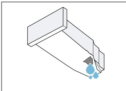
Kontroller filteret i kondensvannbeholderen → Side 42 regelmessig og rengjør det når det er skittent.
