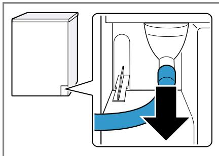
Kondensvannslangen er koblet til stussen fra fabrikk.
